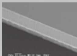
SEM x750 晶圓厚度：30 μm DAF厚度：10 μm
