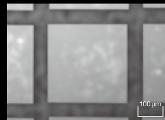
x100 進刀速度: 150 mm/s 晶圓厚度: 90 \mu\text{m}
