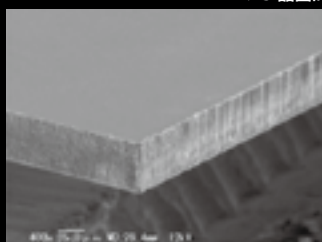
SEM x400 進刀速度: 500 mm/s 3pass 晶圓厚度: 50 \mu\text{m}
